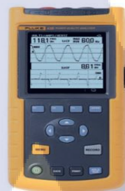
รูปที่ 0.11 เครื่องวัดกำลังไฟฟ้า Fluke 43B
