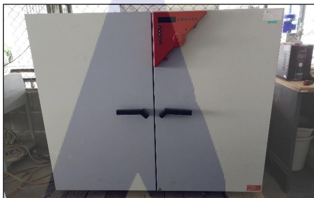
รูปที่ 3.5 อุปกรณ์ที่ใช้เก็บเพื่อลดความชื้นของเศษไม้ยางพารา
