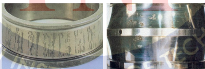
รูปที่ 2.4 ลักษณะสภาพการเสียหายแบบการเกิดสนิมและการกัดกร่อน [16]
