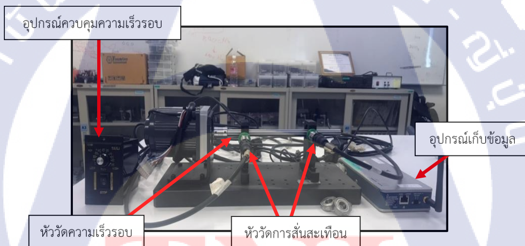
รูปที่ 3.5 ชุดจำลองการทำงานของเบร้งเบอร์ 6001Z
