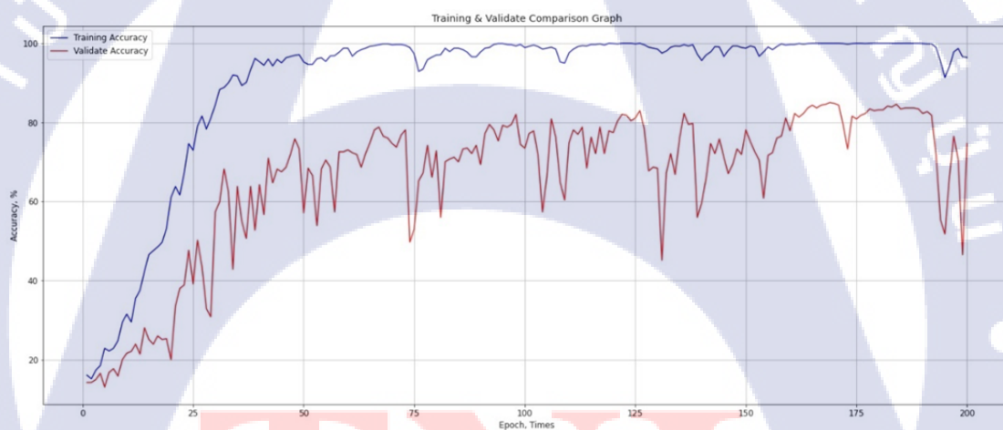
รูปที่ 4.31 ภาพกราฟแสดงผลความแม่นยำในการฝึกสอนของแบบจำลองประเภท VGG รูปแบบที่ 3 ด้วยชุดข้อมูลฝึกสอน CK+ สำหรับในแต่ละวงรอบ
