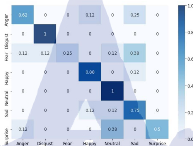
รูปที่ 4.48 ภาพ Confusion Matrix แสดงผลการคัดแยกข้อมูลภายในชุดข้อมูลฝึกสอน JAFFE สำหรับแบบจำลองประเภท VGG รูปแบบที่ 5
