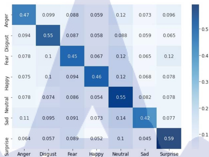
รูปที่ 4.86 ภาพ Confusion Matrix แสดงผลการคัดแยกข้อมูลภายในชุดข้อมูลฝึกสอน FER2013 สำหรับแบบจำลองประเภท Residual รูปแบบที่ 1
