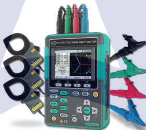
รูปที่ 4.7 อุปกรณ์ Power quality analyzer ยี่ห้อ Kyoritsu
