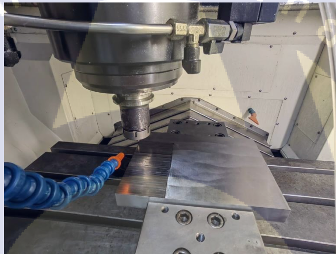
รูปที่ 3.10 การตัดเฉือนบนเครื่องกัด ซี เอ็น ซี Makino รุ่น S33
