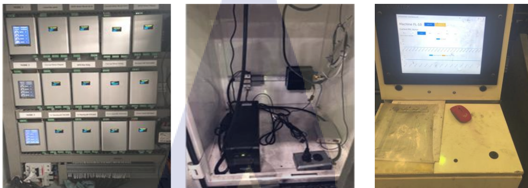
รูปที่ 4.7 อุปกรณ์ IoT (Converter Node Gateway Datamixer)
