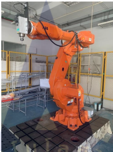
รูปที่ 3.9 หุ่นยนต์ที่ใช้ในการทดลอง และชุดสปินเดิลมอเตอร์
