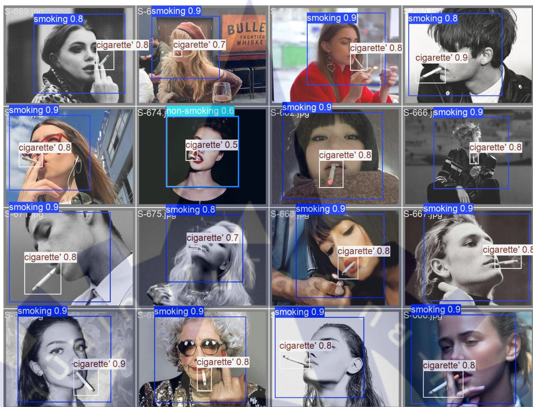
รูปที่ 4.62 รูปผลลัพธ์จากการทดสอบฝึกสอนโมเดล ชุดข้อมูล 90 ส่วน 10 การฝึกสอนจำนวน 50 รอบ
