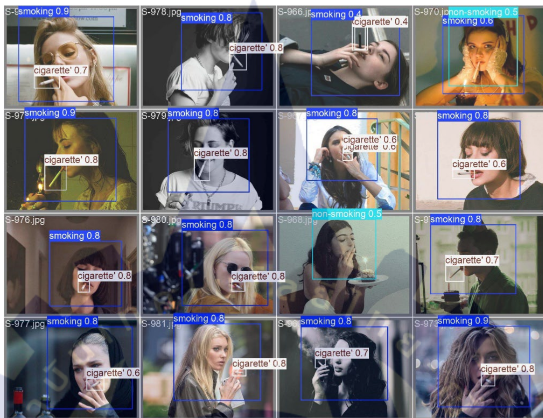
รูปที่ 4.69 รูปผลลัพธ์จากการทดสอบฝึกสอนโมเดล ชุดข้อมูล 50 ส่วน 50 และการฝึกสอนจำนวน 50 รอบ
