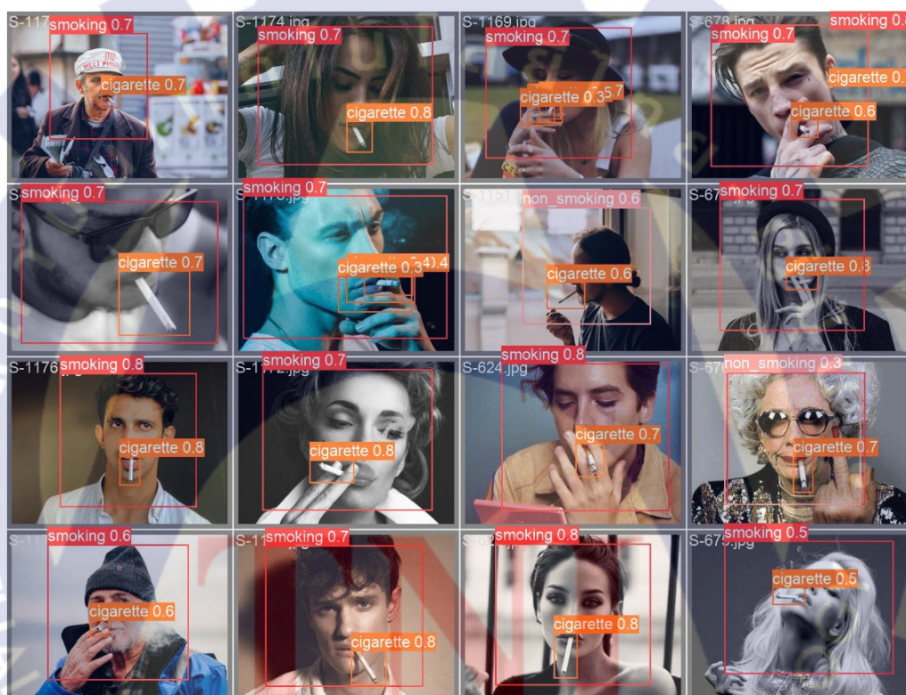
รูปที่ 4.7 รูปผลลัพธ์จากการทดสอบฝึกสอนโมเดล ชุดข้อมูล 50 ส่วน 50 และการฝึกสอนจำนวน 150 รอบ
