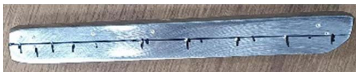
รูปที่ 3.6 ชิ้นงานที่ถูกตัดเพื่อเตรียมทดสอบความแข็ง
