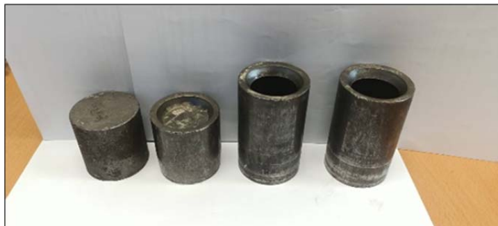
รูปที่ 4.9 ชิ้นงานที่ผ่านกระบวนการทุบขึ้นรูปเย็น
