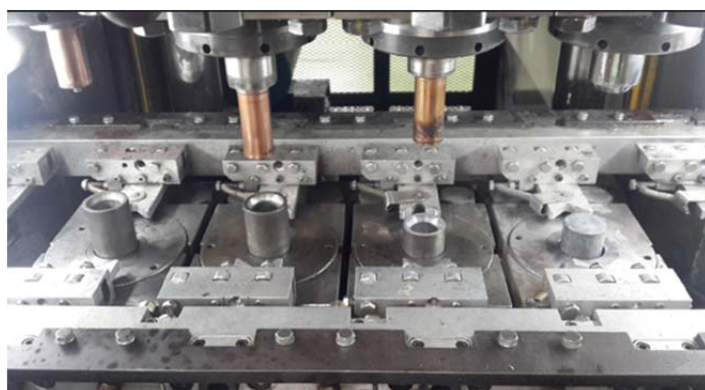
รูปที่ 3.4 กระบวนการชุบขึ้นรูปเย็น
