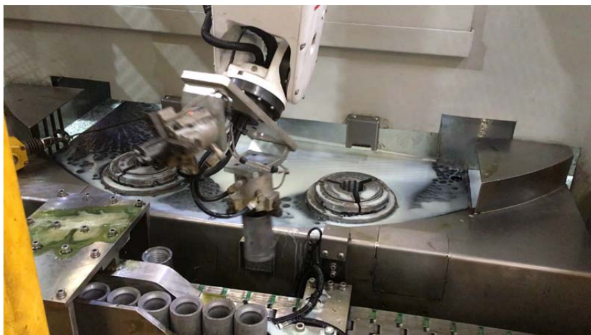
รูปที่ 2.3 กระบวนการทำเกลียวใน (Taping) ขึ้นงานด้วยหุ่นยนต์
