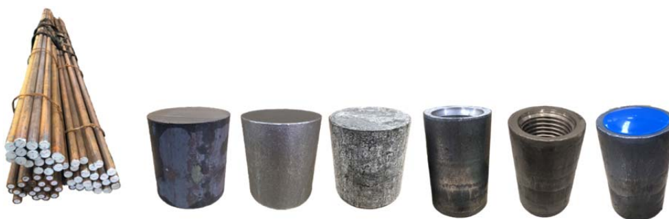
รูปที่ 2.1 กระบวนการผลิต Mechanical Coupler
