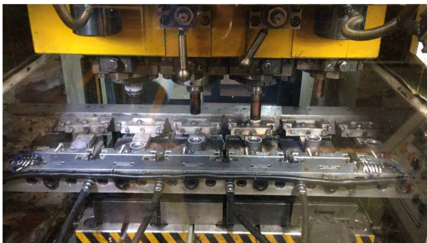
รูปที่ 2.2 การทุบขึ้นรูปเย็น Mechanical Coupler
