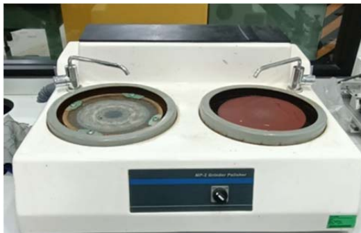
รูปที่ 3.7 เครื่องขัดผิวชิ้นงานก่อนทำการวัดค่าความแข็งของชิ้นงาน (MP-2 Grinder Polisher)
