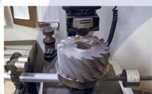
กระบวนการทดสอบความแข็งแรงของโลหะ (Hardness testing)
