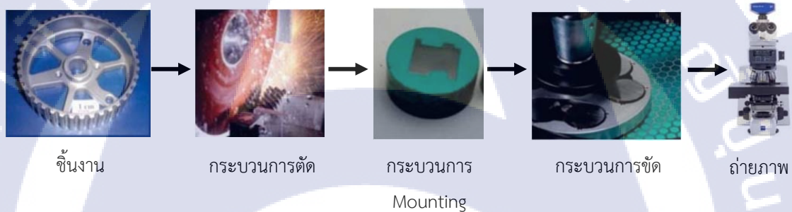
รูปที่ 3.1 ขั้นตอนการเตรียมชิ้นงานโลหะเพื่อทำการส่องดูภาพผ่านกล้องจุลทรรศน์
