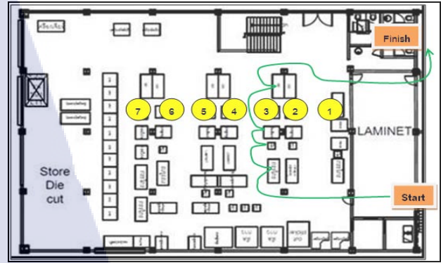
รูปที่ 6 การวางผังเครื่องจักรตามผลิตภัณฑ์ (หลังการปรับปรุง)
