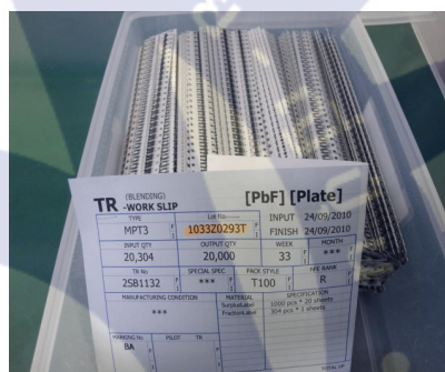
รูปภาพ : การเตรียม Lot dummy เพื่อนำไปตรวจค่าทางไฟฟ้า
