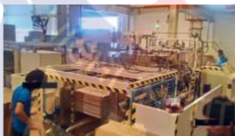
รูปที่ 3.8 : สถานีงานที่ 4 กระบวนการแพ็คก กล่องบรรจุสินค้า (Carton Packing Unit)
